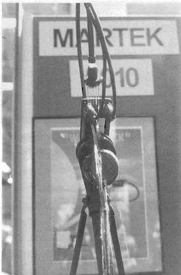
Foto 45 - Coprendo i connettori con lo speciale nastro presentato in questo stand, il tutto diventa talmente stagno da permettersi un "doccia continua".
